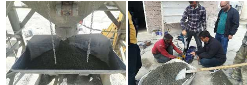
Şekil 5. Hazır beton santralinde hazırlanan deneme beton üretimi ve numune alımı
