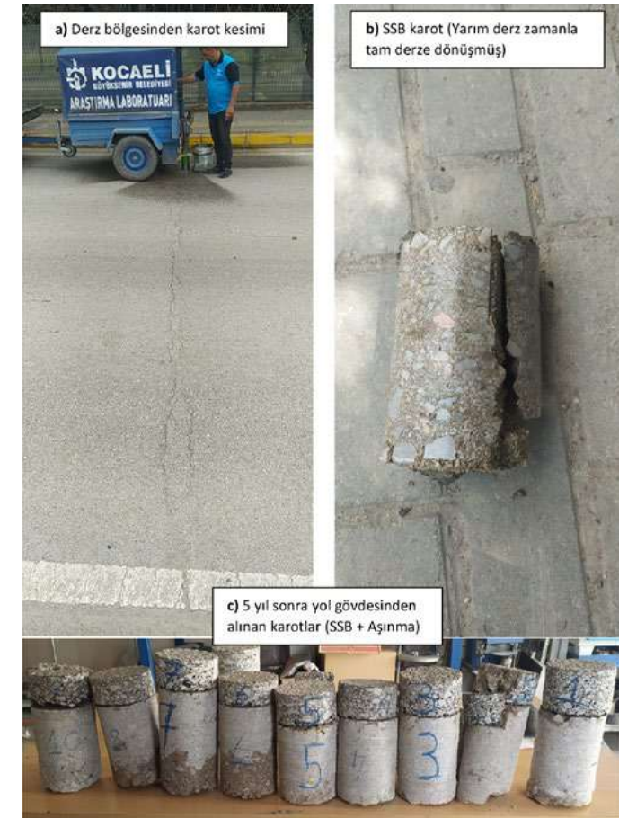
Şekil 9. Kaplama gövdesinden alınan karot numuneleri (2022)
