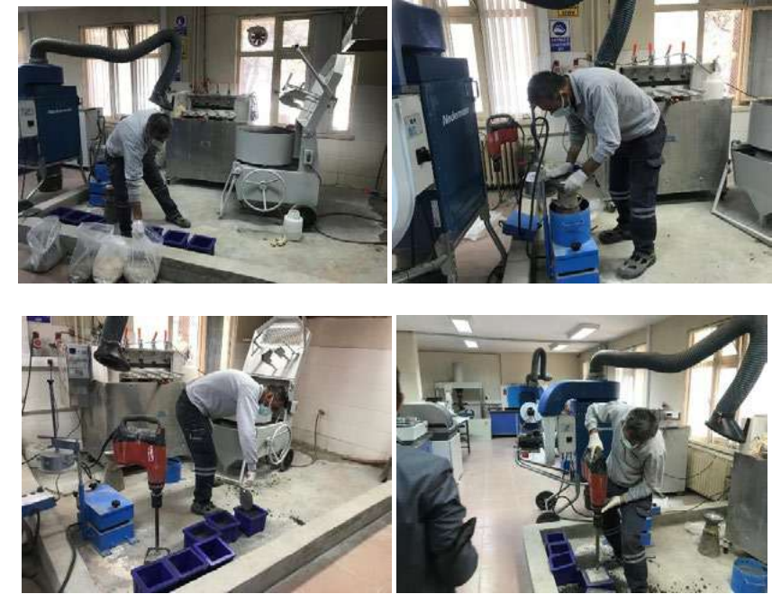
Şekil 4. TÇMB Yapı Laboratuvarında yapılan SSB yol imalatında kullanılacak beton deneme karışımları
