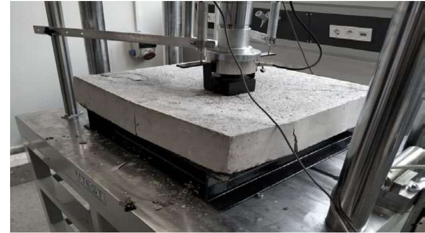
Şekil 4. Enerji Yutma Kapasitesinin Tayini Deneyi
