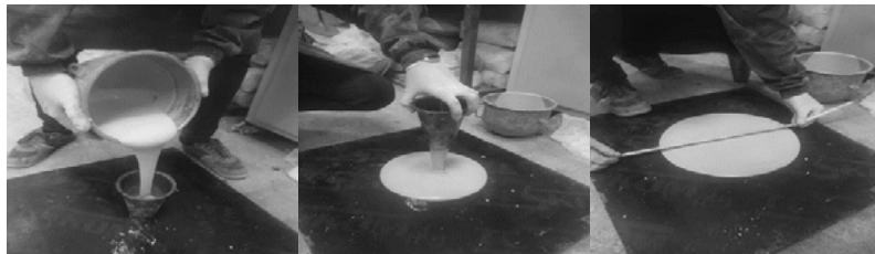
Şekil 1. Referans matrise ait mini yayılma çapı testi
